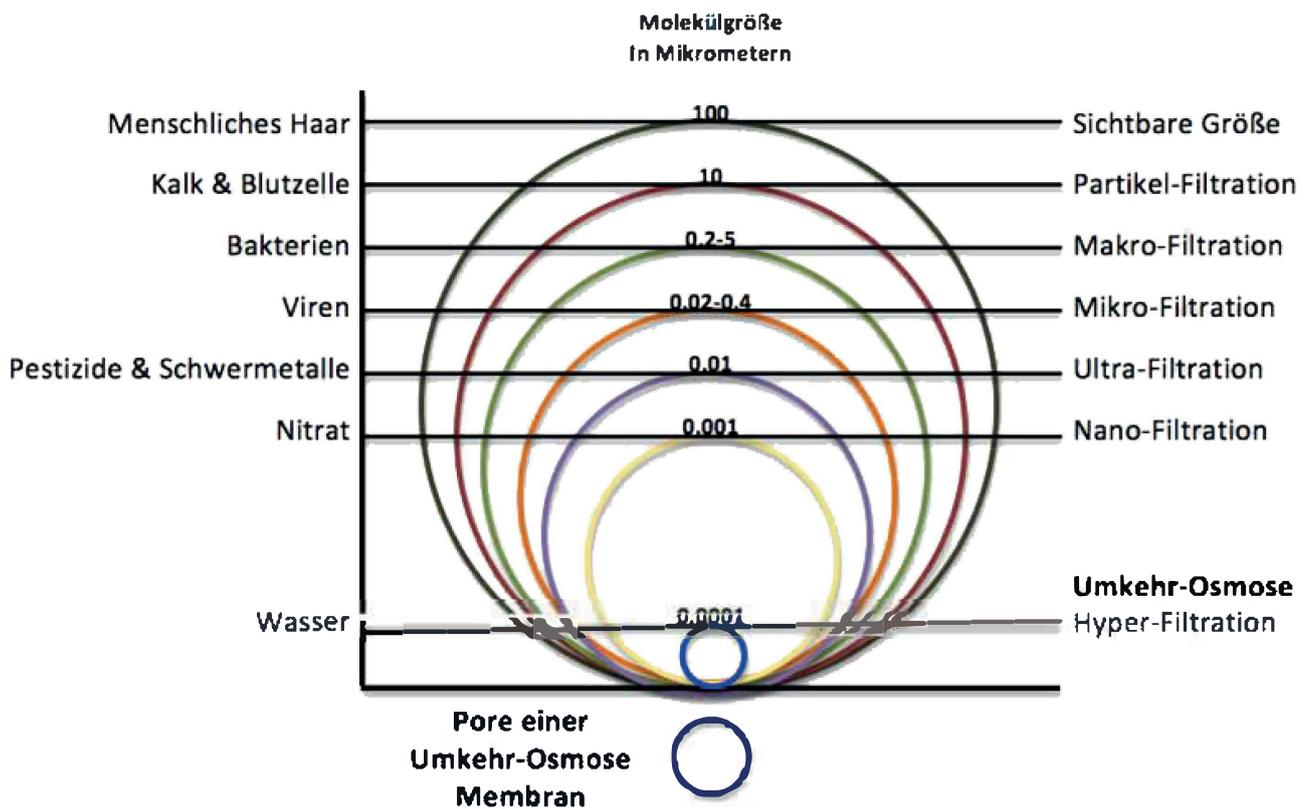
Das Wassermolekül ist das kleinste Molekül von allen vorkommenden Stoffen. Die Poren der Membrane sind gerade so groß, dass nur Wassermoleküle durchgelassen werden.
